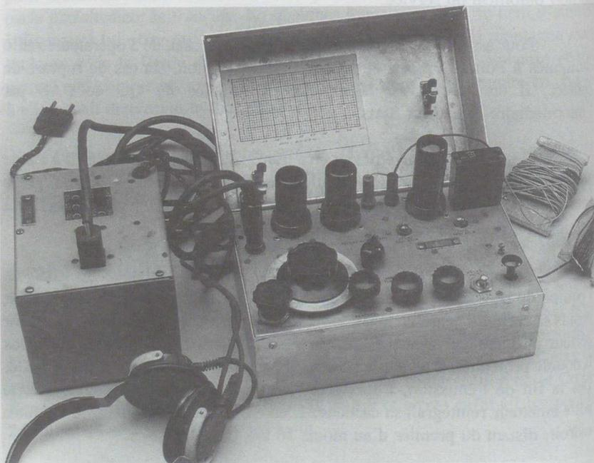
Fig. 11. Le Paraset : un des modèles d'émetteurs-radio parachutés par les services secrets britanniques pour la Résistance.
